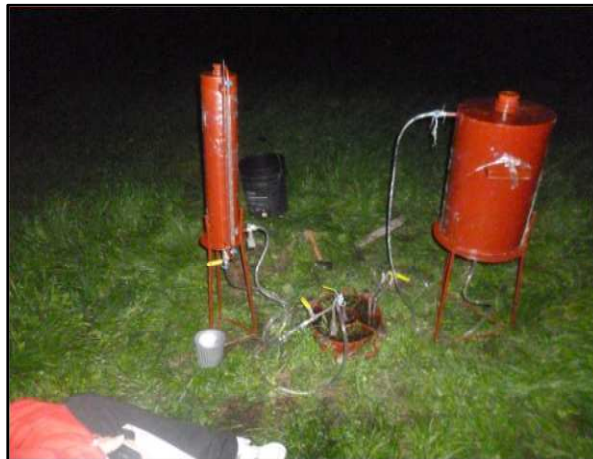
Figura 11: Infiltrómetro doble anillo de Muntz
