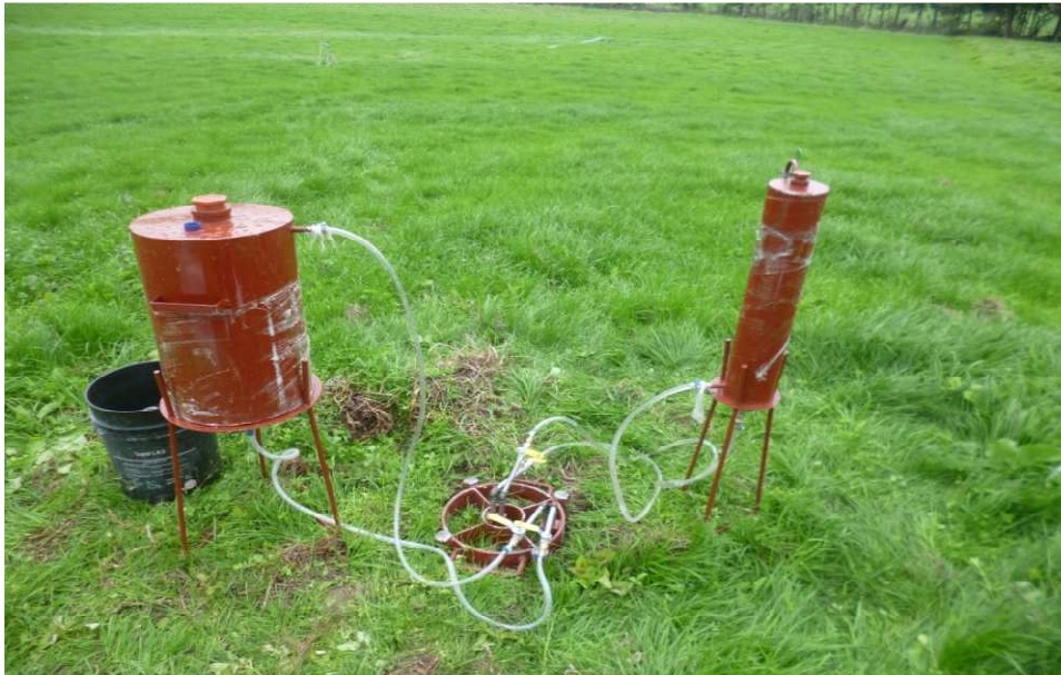
Figura 13. Equipo de infiltración doble anillo de Muntz utilizado
