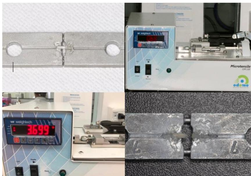
*Figura 8. Prueba de microtracción.*
