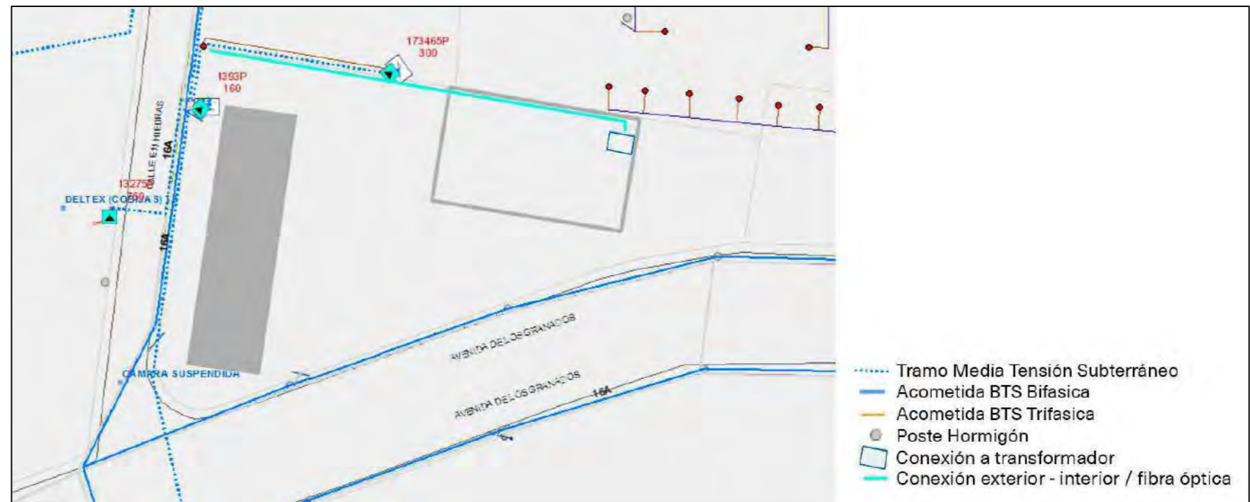
Figura 187. Red eléctrica y de datos en el Lote.
