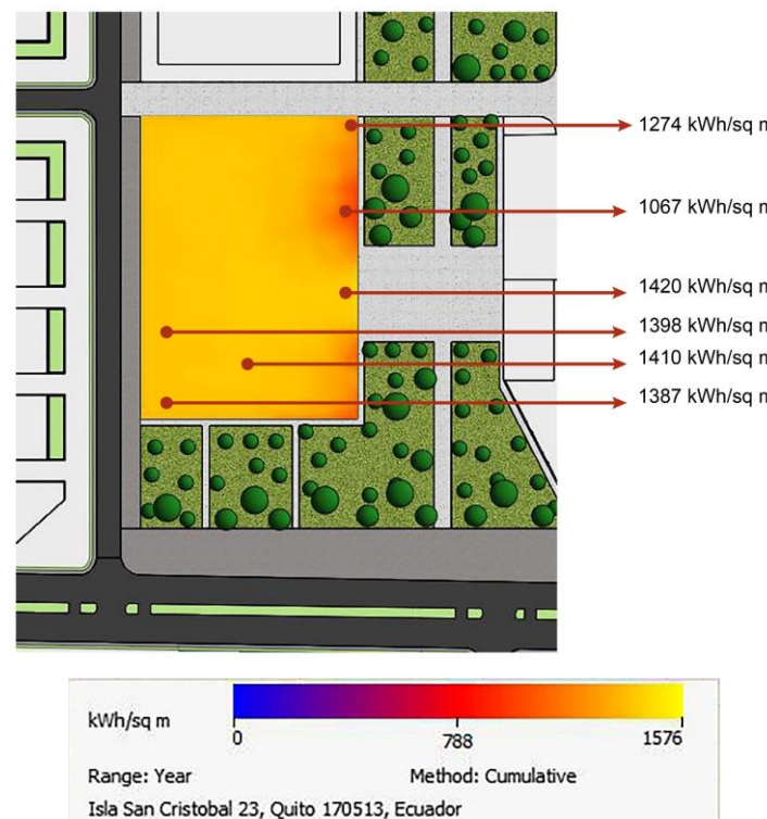
Figura 71. Incidencia Solar Lote en planta.
