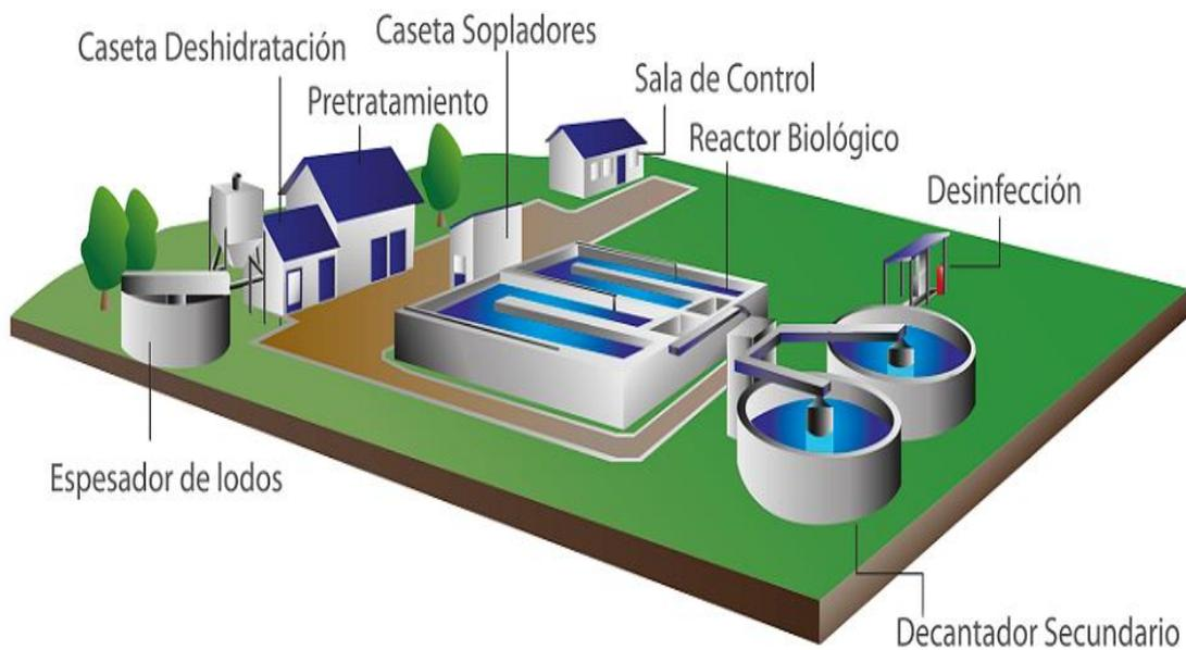
Figura 27. Planta de tratamiento de aguas servidas
