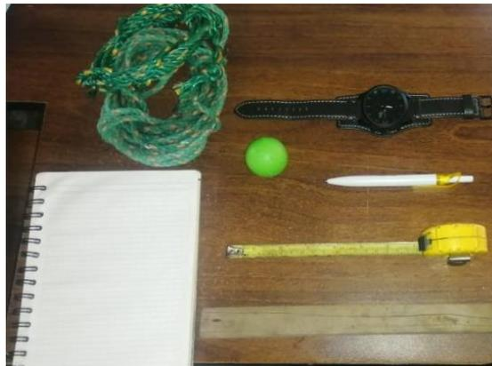
*Figura 109.* Materiales medición de caudal mediante sistema método de flotación
