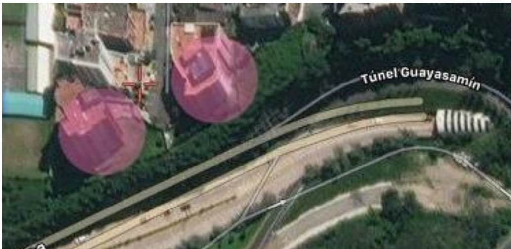
Figura 35. Zonas residenciales con niveles diurnos entre 70 - 75 dBA - Sector Bellavista.
