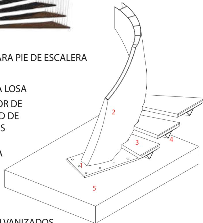
SOPORTES TENSADOS EN EXTREMO EXTERIOR DE ESCALONES, ANCLADOS DE LA MISMA MANERA A LA LOSA
