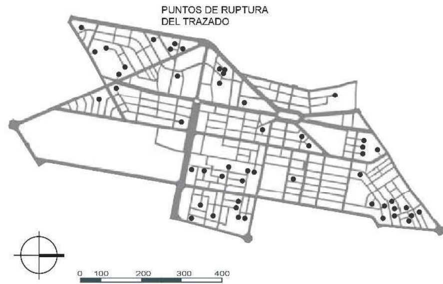
FIGURA 16. PROBLEMÁTICA DE RUPTURAS VIALES, FALTA DE CONTINUIDAD. TOMADO DE (P.O.U.2019)
