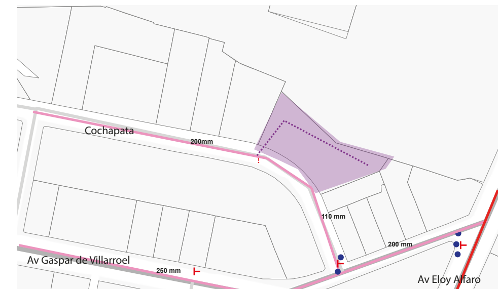
Figura 146. Conexión a la tubería
