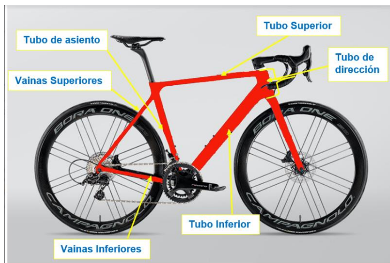
Figura 6. Partes que constituyen un cuadro de bicicleta Tomado de: (Señal Colombia, 2019)
