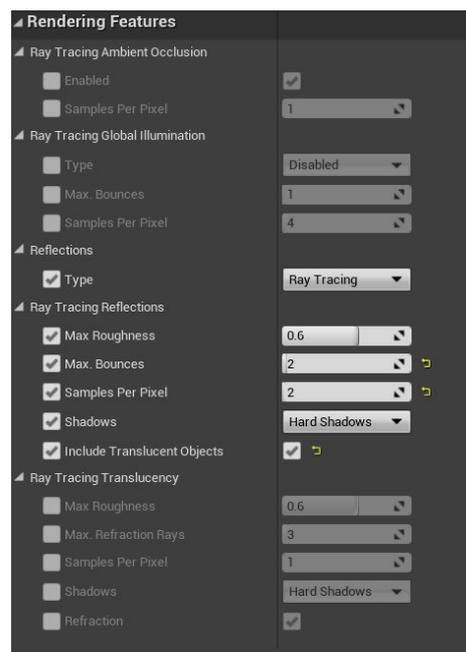
Figura 12, Configuración de Ray Tracing en UE4. Tomado de: UE4
