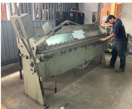
Figura 39. Proceso de doblado.
