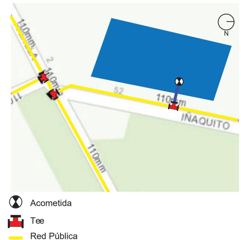
Figura 104. Acometida de agua potable
