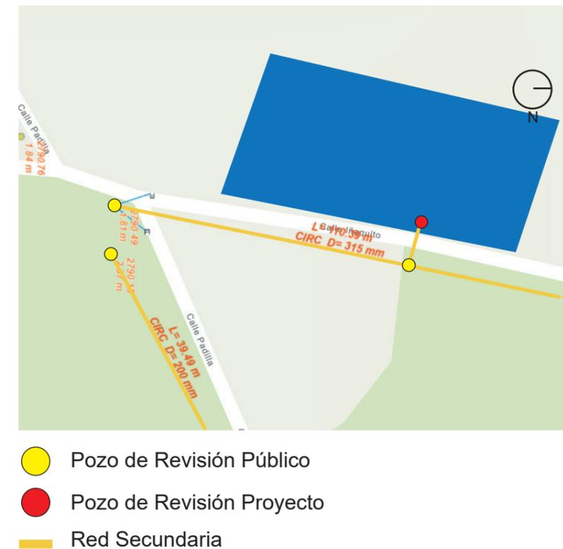
Figura 108. Acometida a la red de alcantarillado
