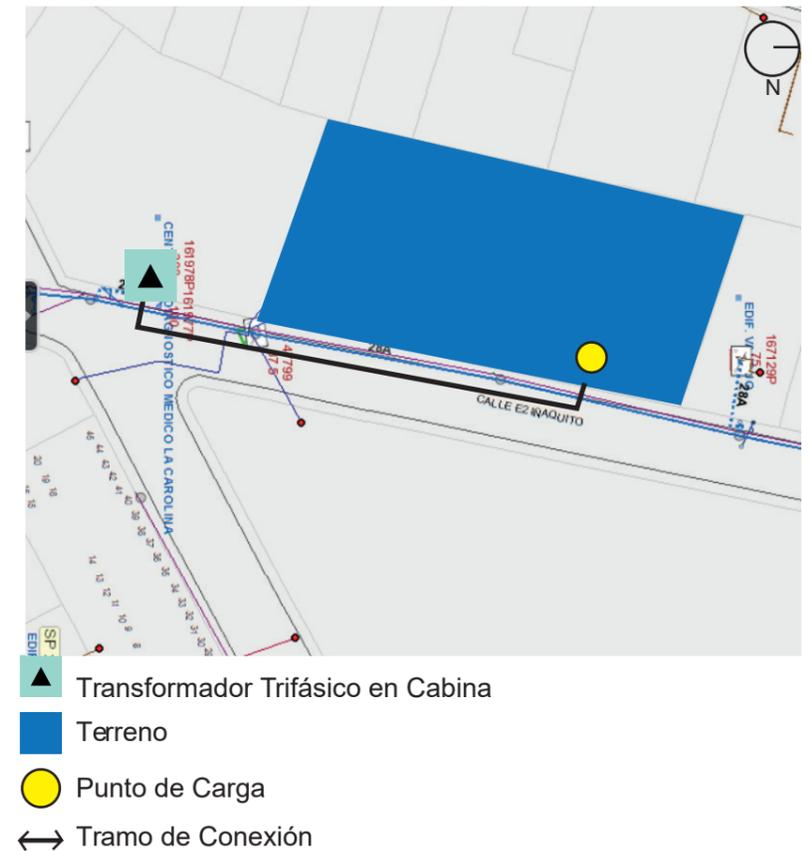
Figura 102. Acometida de energía eléctrica
