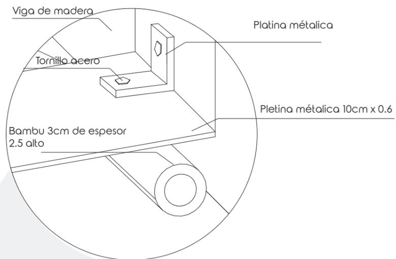
Detalle anclaje final (altura 2.5M)
