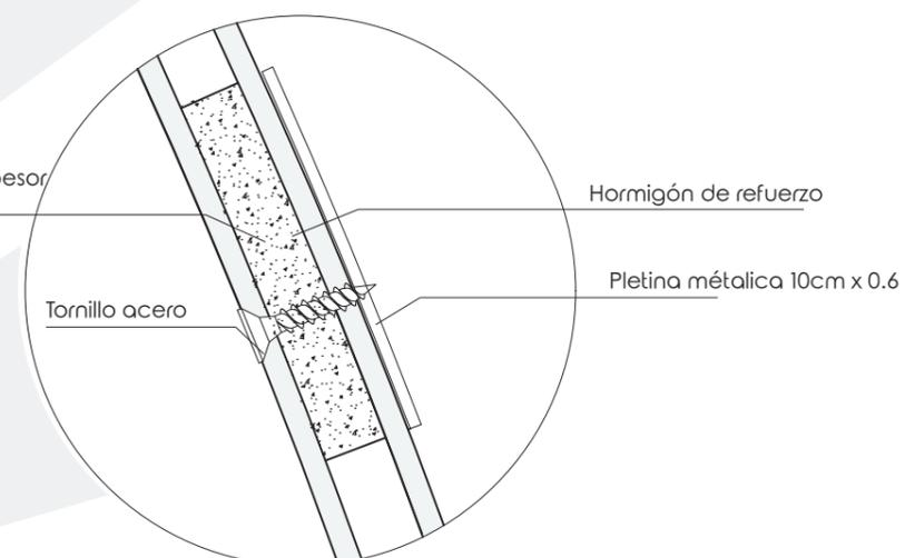
Detalle anclaje medio (altura 1.5 M)
