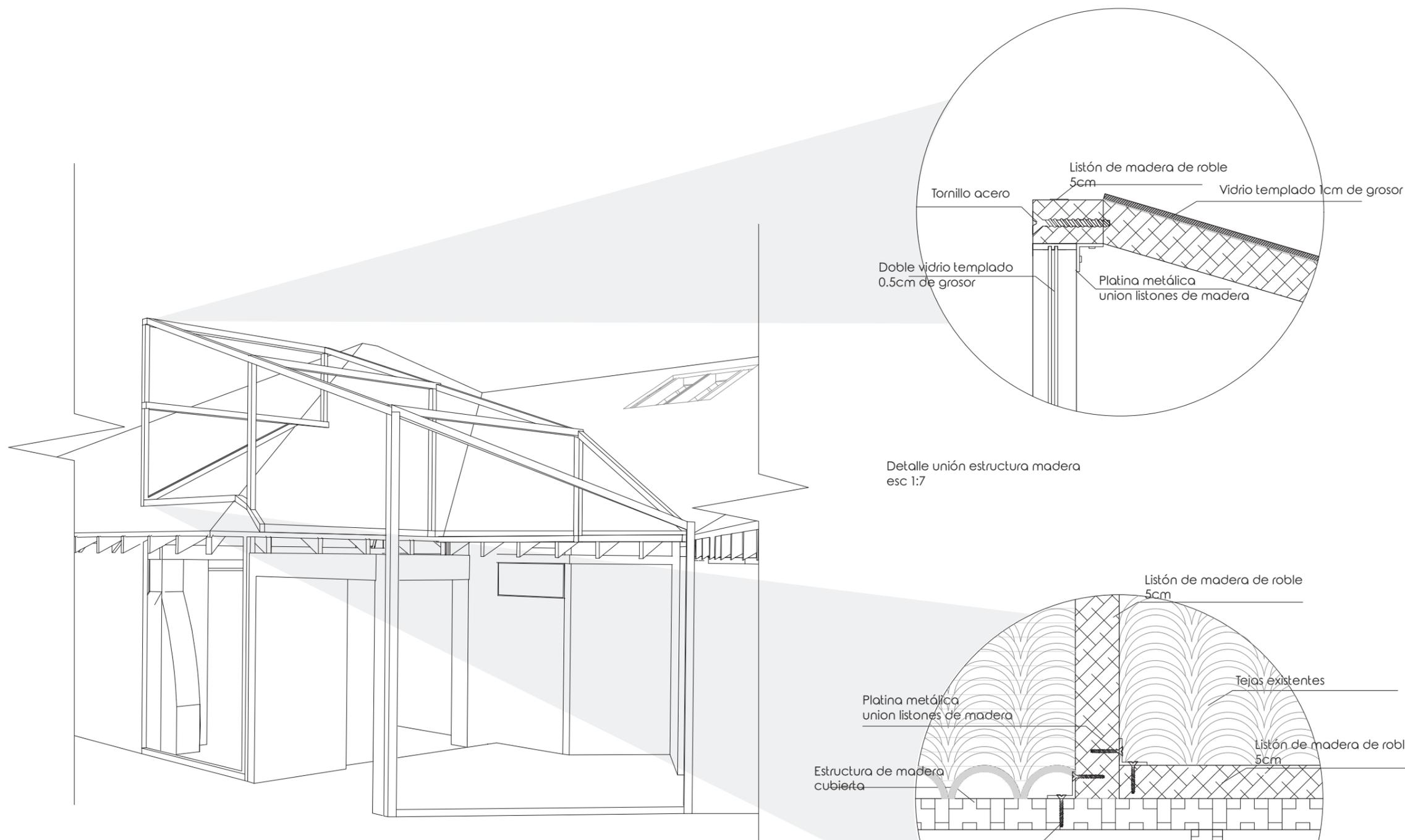
Detalle unión estructura madera
