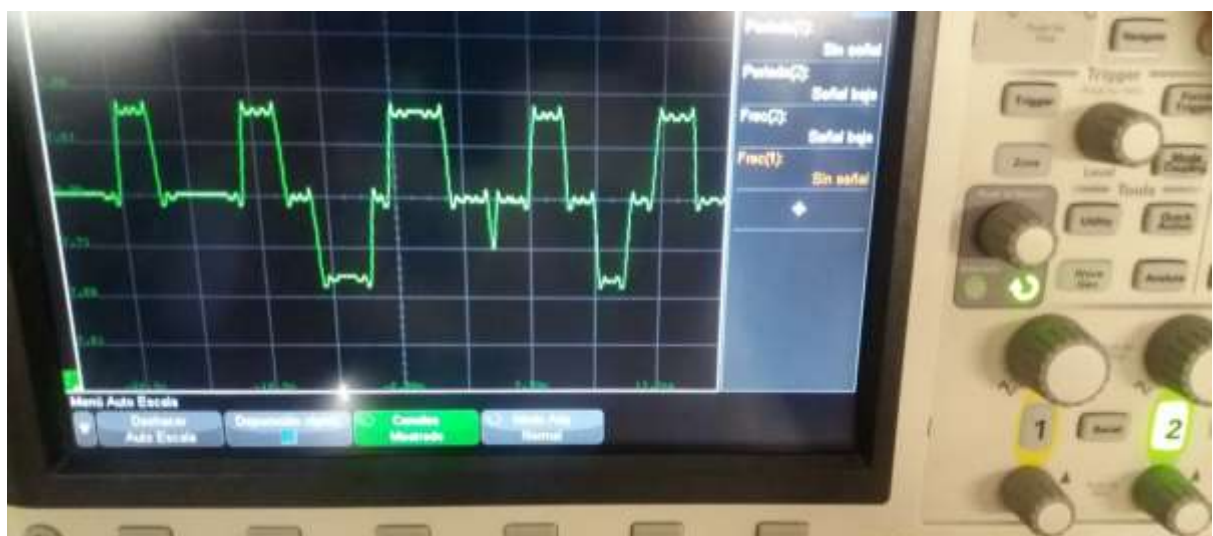
Figura 20 Onda generada en el pin 2 del integrado XR 2206.
