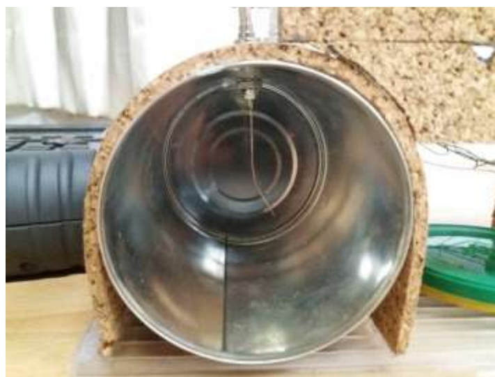
Figura 6 Primer plano de una de las antenas del SAR de la UDLA.
