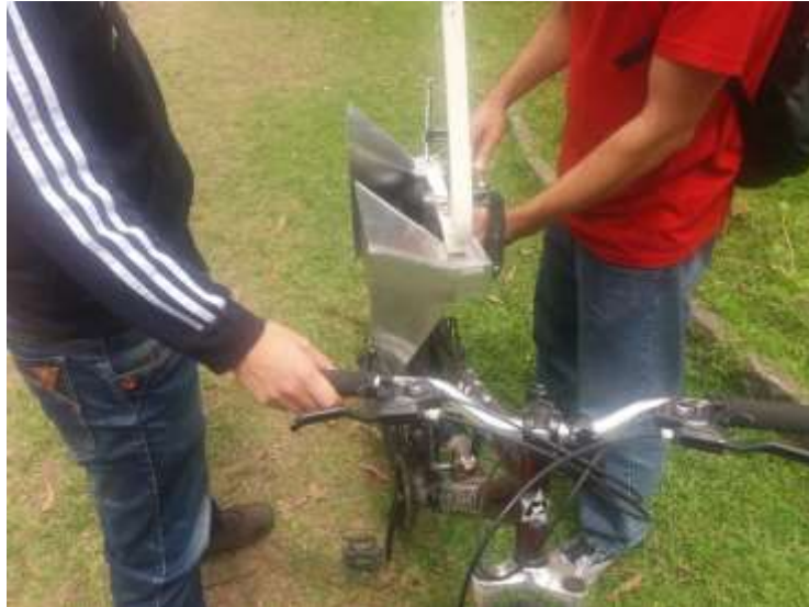
Figura 65 Montaje de radar sobre una bicicleta para tener movilidad.
