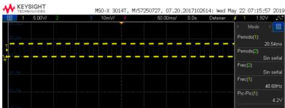
Figura 59 Salida del integrado XR 2206 Pin 11. Onda cuadrada. Periodo 20ms
