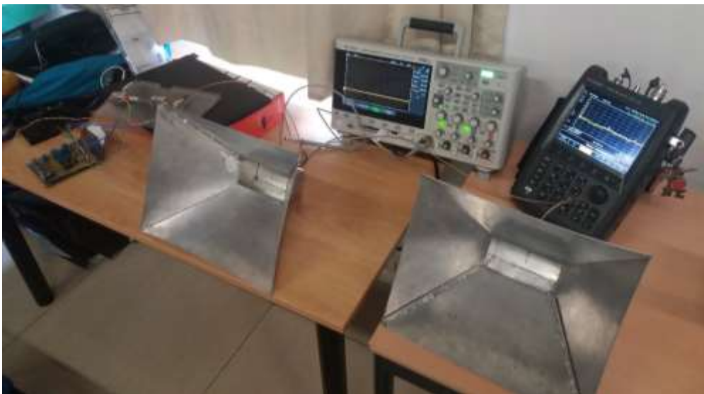
Figura 57 Conexiones del radar de apertura sintética con las nuevas antenas.
