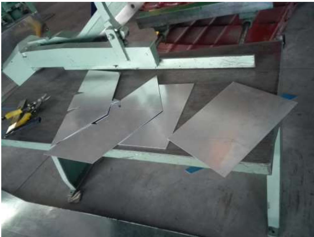
Figura 43 Inicio de proceso de construcción de las antenas HORN.
