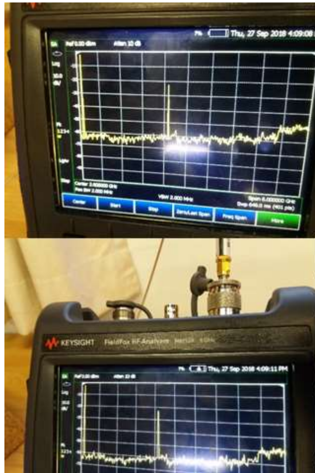
Figura 9 Medidas de potencia tomadas directamente al splitter del SAR con respecto al analizador de espectros Keysight N9912a.
