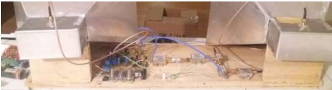
Figura 66 Montaje de un radar sobre una superficie plana deslizable.
