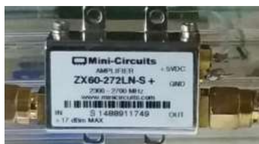
Figura 26 Circuito amplificador ZX60-272LN-S+ Mini-Circuits.
