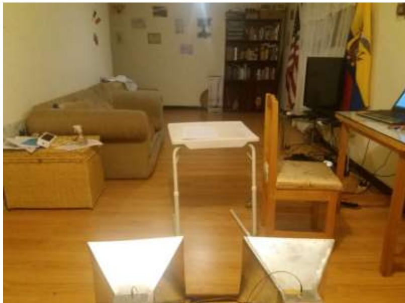
Figura 71 Foto locación 1 con la presencia de objetos a 1.5 y a 18 pies de distancia con respecto al radar.
