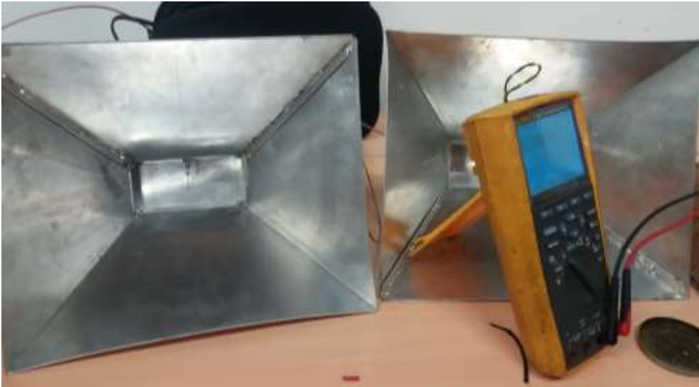
Figura 58 Antenas de recepción y transmisión conectadas al radar de apertura sintética.
