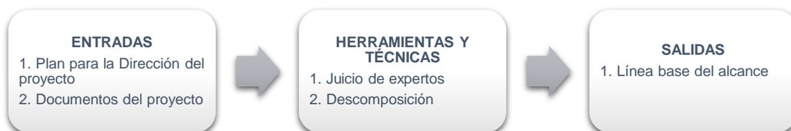
*Figura 4.* Entradas, herramientas y técnicas y salidas de Crear la EDT/WBS
