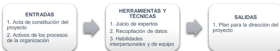
*Figura 2.* Entradas, herramientas y técnicas y salidas de Desarrollar el Plan para la Dirección del proyecto
