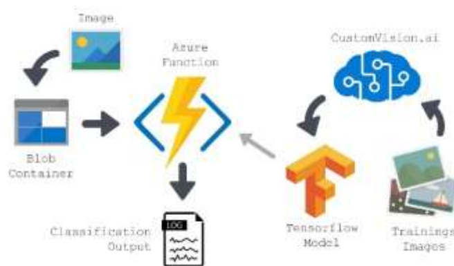
Figura 3: Funcionamiento de Azure Custom Vision Service.
