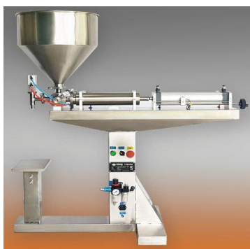
Figura No. 1: Dosificadora Tomado de: Astimec.
