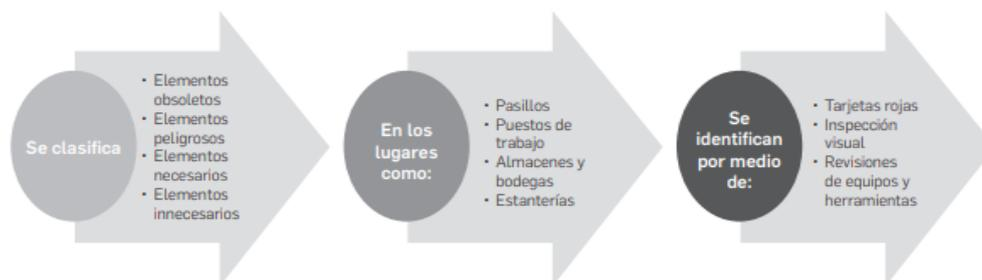
Figura 16. Procedimiento para identificación de elementos
