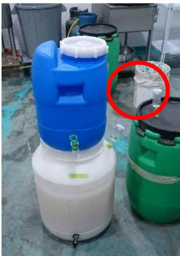
*Figura 66.* Tanque para guardar producto en proceso en mal estado
