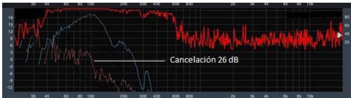
Figura 46. Visualización de la cancelación en la práctica, Línea Azul (Caja Frontal), Línea Verde (Caja Posterior).
