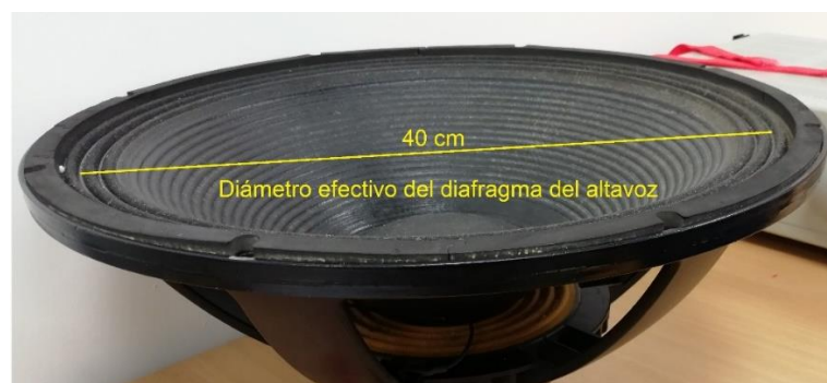
Figura 21. Diámetro efectivo del diafragma del altavoz.
