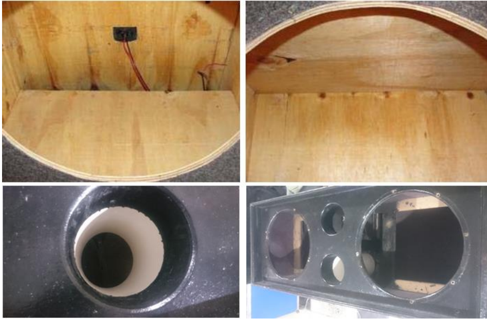
Figura 34. Imágenes del proceso de construcción de la caja acústica.
