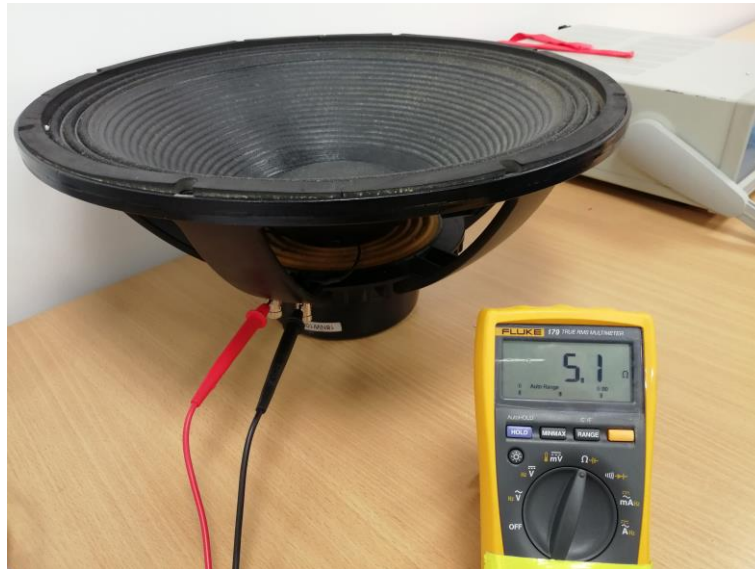
Figura 18. Medición del parámetro R_e del altavoz B&C 18NW100.
