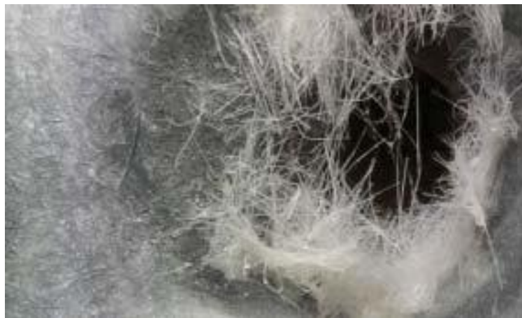
Figura 35. Fibra de Vidrio utilizada para la Caja Acústica.
