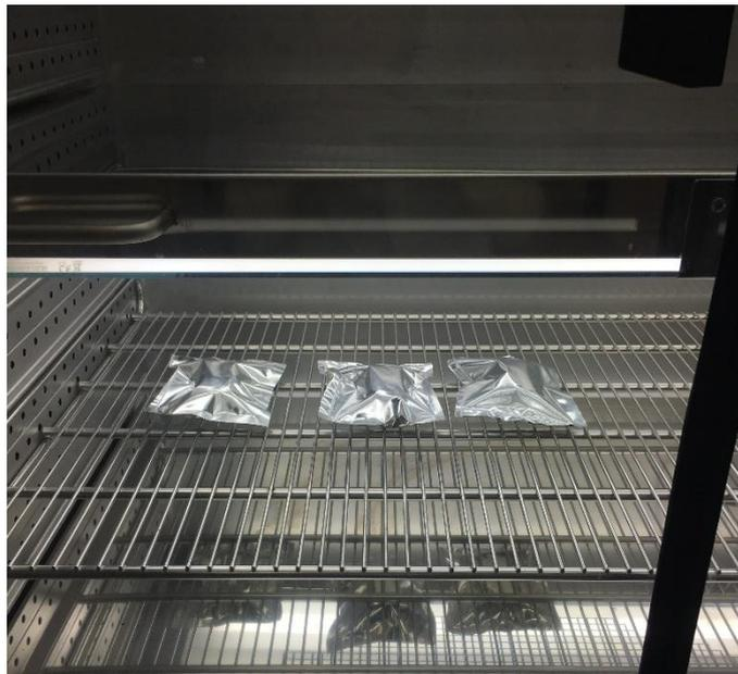
**Anexo 8: Prueba de vida útil en la cámara de estabilidad**
