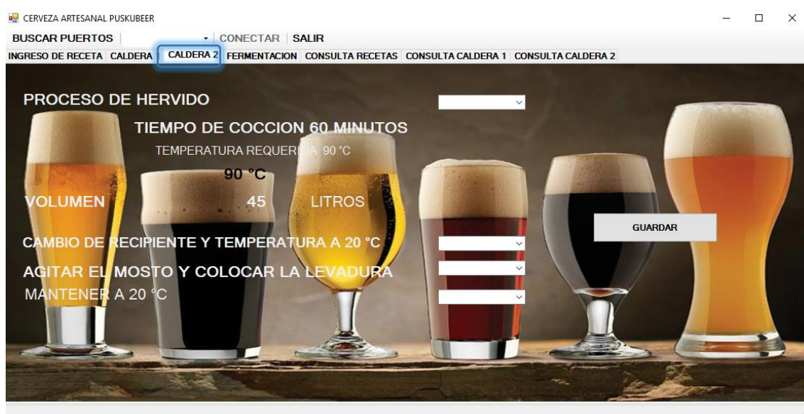
Figura 25 Interfaz de registro y monitoreo de la Temperatura de la Caldera 2
