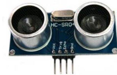
Figura 13 Sensor ultrasónico HC-SR04
