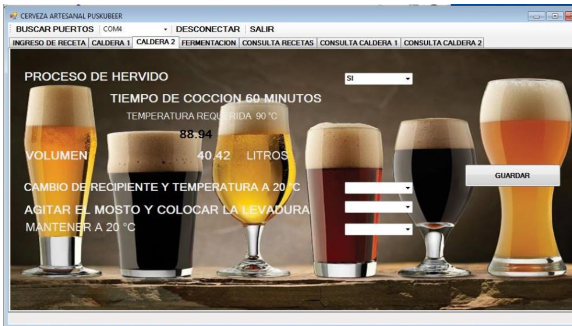
Figura 52 Ingreso de procedimientos caldera 2
