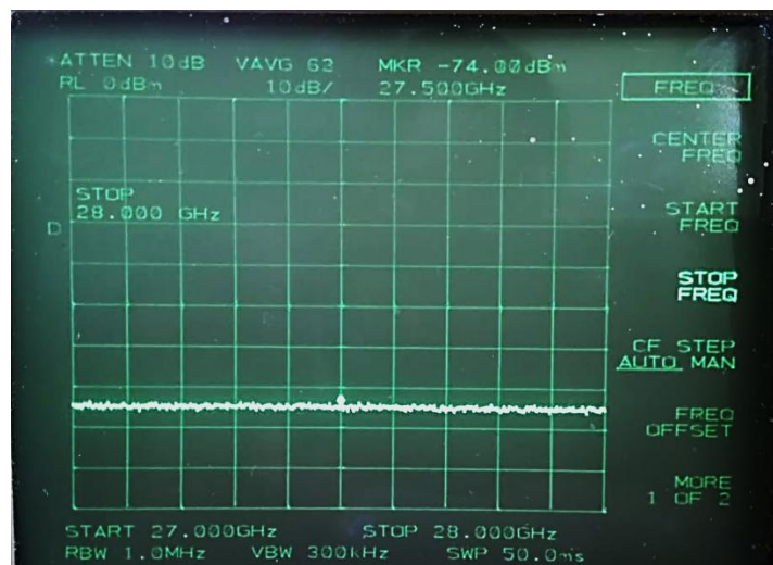
Figura 58. Monitoreo del espectro con el analizador de espectro HP 8546E, en el rango de 27 a 28 GHz – Quito.
