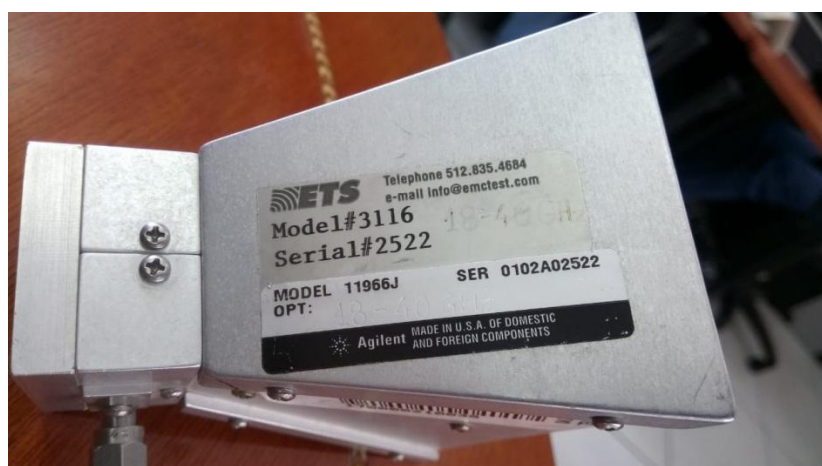
Figura 54. Antena ETS 3116 rango de operación de 18 – 40 GHz.
