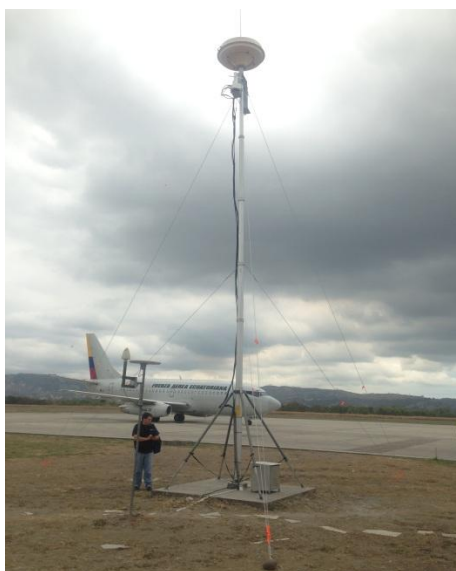
Figura 23. Antena R&S HE500 - Aeropuerto Coronel Carlos Concha Torres – Esmeraldas.
